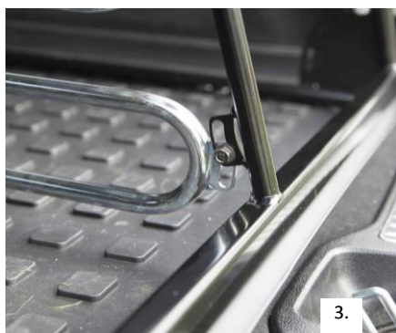
Bild nr 1: Övre fästet på avdelaren. Bild nr 2: Avdelare monterad Bild nr 3: Nedre fästet på avdelaren. Bild nr 4: Nedre fästet på grinden golvram.
